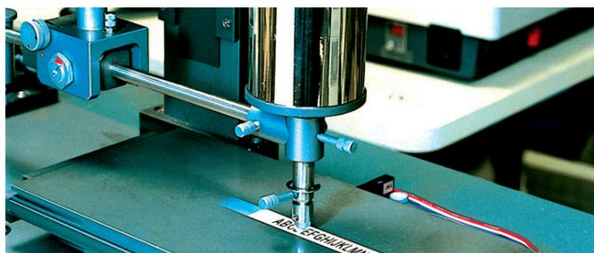
Resistentes a la abrasión: Un dispositivo con 1kg de peso se pasa sobre las etiquetas laminadas. Después de 50 pasadas (ida y vuelta) los caracteres de las cintas laminadas permanecieron inalterados y en la capa de laminación apenas se produjeron unos rasguños.
