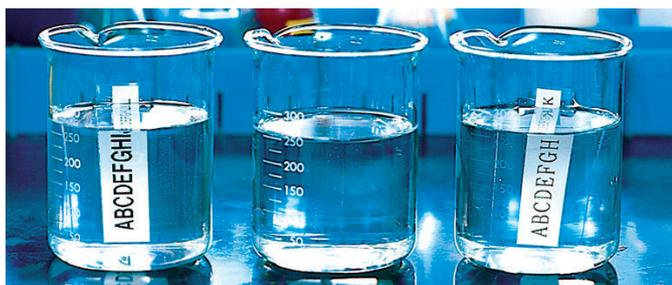
Resistentes al agua y a productos químicos: las cintas laminadas se pegaron sobre placas de cristal y fueron sumergidas en diferentes líquidos durante 2 horas. No se apreció ningún cambio relevante en el aspecto o en la estructura de las etiquetas y todas permanecieron pegadas.
