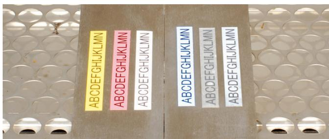
Resistentes a temperaturas extremas: Las etiquetas laminadas se fijaron a placas de acero inoxidable, se calentaron y se enfriaron durante un tiempo. Los resultados muestran que pueden resistir temperaturas de entre  $-80^{\circ}\text{C}$  y  $+150^{\circ}\text{C}$ .
