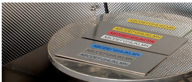
Resistentes a la decoloración: Las etiquetas laminadas en varios colores fueron fijadas sobre capas de acero inoxidable y expuestas a un simulador de rayos ultravioleta durante 12 meses, y no se observaron cambios.
